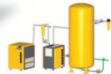
Modelo de instalación 2: Diseño para instalaciones con demanda de aire comprimido muy variable. Consta de un compresor, un separador centrífugo, secador frigorífico y depósito de presión, en este orden
