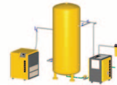
Modelo de instalación 1: Concepción más habitual, con compresor, depósito de presión y secador frigorífico en este orden
