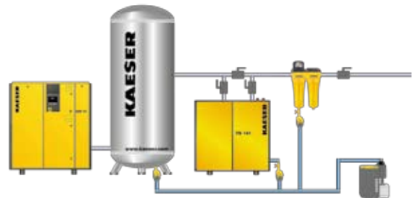
Druckluft-Aufbereitung (Filter, Kondensat-Aufbereitung, Adsorptionstrockner, Aktivkohleadsorber)
